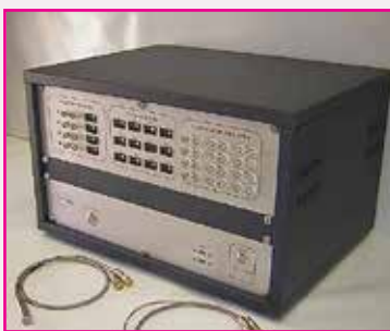
DIAMon Plus: ελληνικό σύστημα με αισθητήρες παρακολούθησης του πολυμερισμού της μήτρας συνθέτων υλικών
